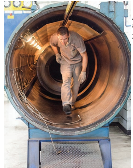
VULCANIZAÇÃO. Nesta câmara, pneus passam pelo processo de fusão dos elementos que irão renová-lo
